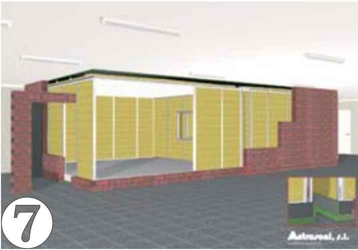
7 Realización de sandwich en techo aislante y colocación de perfilera para trasdosado con fibra en su interior.
