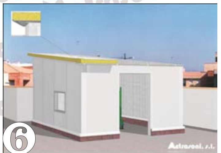
Colocación de techo con saliente para evitar la entrada de agua en el recinto, la fijación del panel techo al tabique por medio de perfiles en forma de "L".
