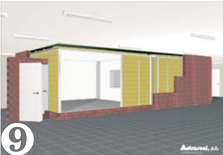
9 Colocación de puertas acústicas MS-1 o MS-2 y visores acústicos
