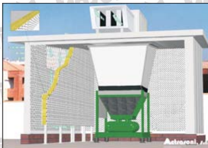
Detalle de embocadura al silenciador y de una segunda opción consistente en un doble panel que permitiría un mayor aislamiento acústico
