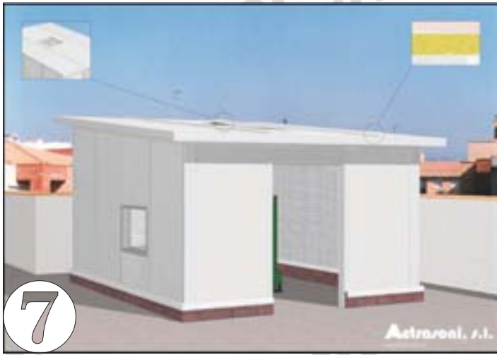
Colocación de techo con encajonado para caseta del silenciador y acabado de cantos con perfiles en forma de “U”.
