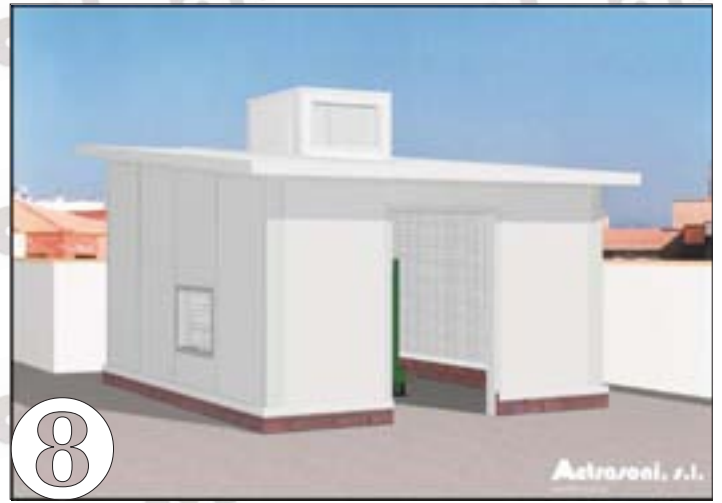
Montaje de caseta de silenciador con perfiles de sujeción en forma de “L”.
