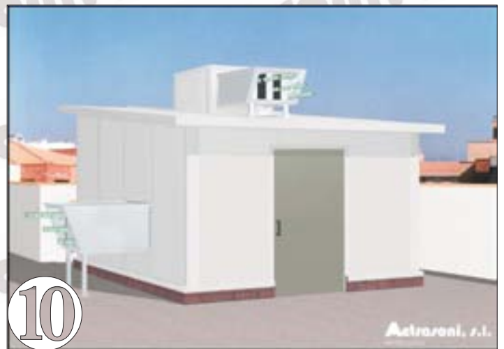
Colocación de puerta acústica de acceso (montar con hoja cerrada)
