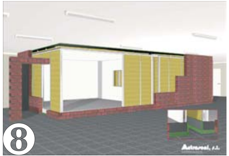
8 Realización de trasdosado en paredes compuesto por dos placas de cartón yeso a rompejuntas con una lámina amortiguante intermedia.
